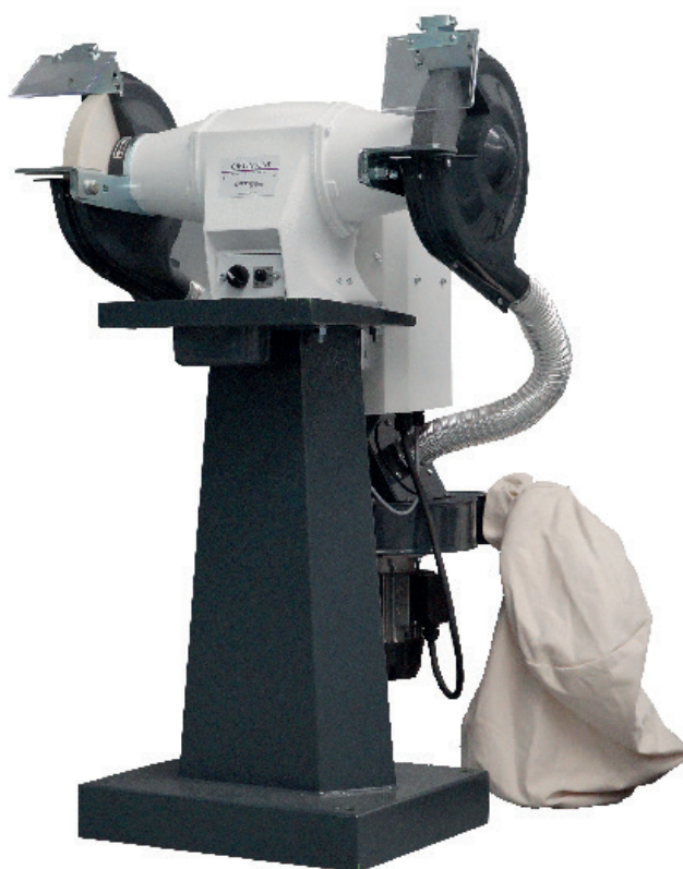
Vario Opção 2 Chassi com unidade de extração Figura com esmerilador opcional
