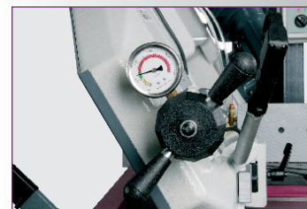
Manômetro > Controlo da tensão da fita de serra simples e preciso
