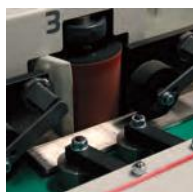
Opção: Lamelas duplas em contra-rotação para o arredondamento de arestas depois do acabamento lateral
