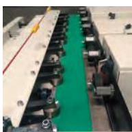
Ajustamento único com sistema de rolos calcadores laterais: pressão constante ao longo de todo o comprimento da barra
