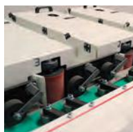
Estações de acabamento lateral com oscilação vertical para um desgaste uniforme das cintas de lixa
