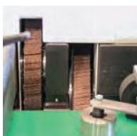
Opção: Lamelas duplas em contra-rotação para o arredondamento de arestas depois do acabamento lateral
